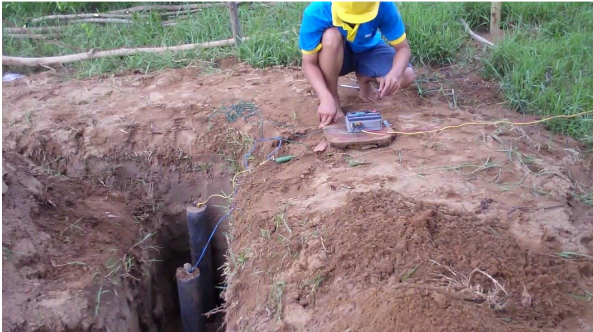
Hình 2.3: Hai cọc, a = 0.5\text{m} , L_C = 1\text{m} , C = 0.05\text{m}
