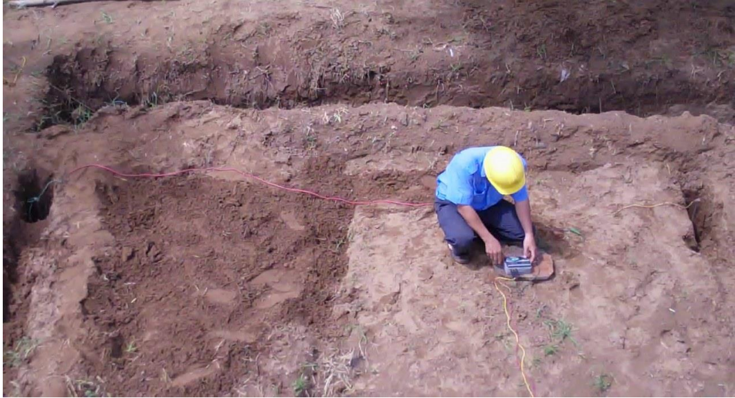
Hình 2.2: Hai cọc, a = 4 m, L_C=1 m, d = 0.01 m
