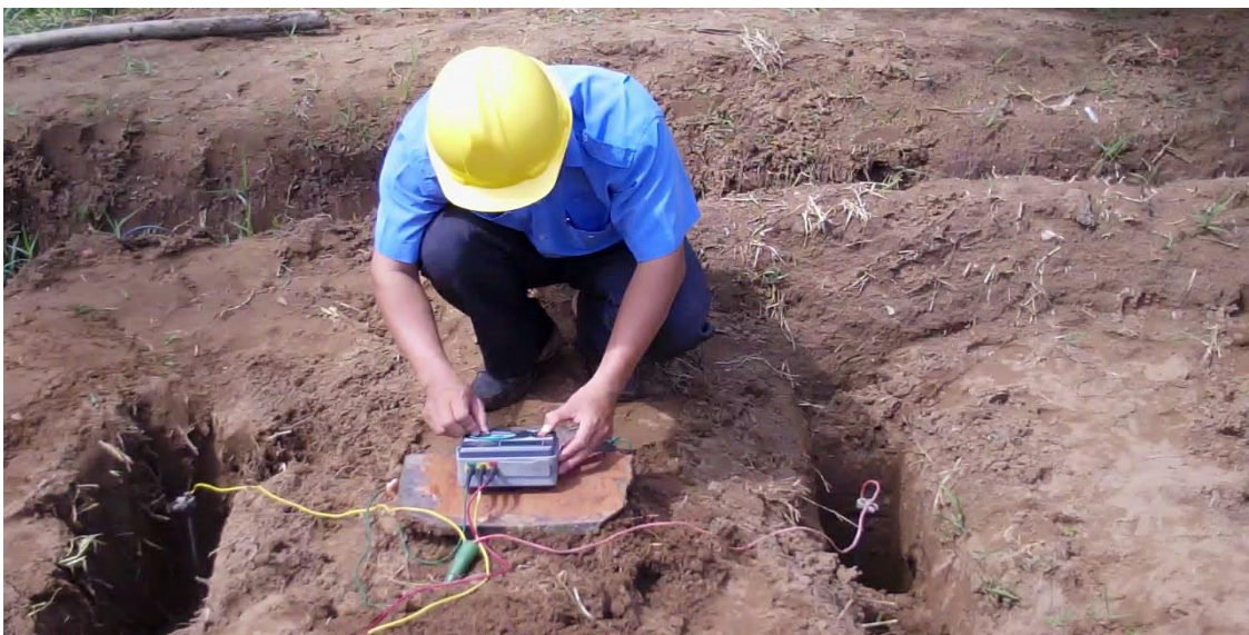
Hình 2.1: Hai cọc, a=1.0 m, L_c=1m , d=0.01m
