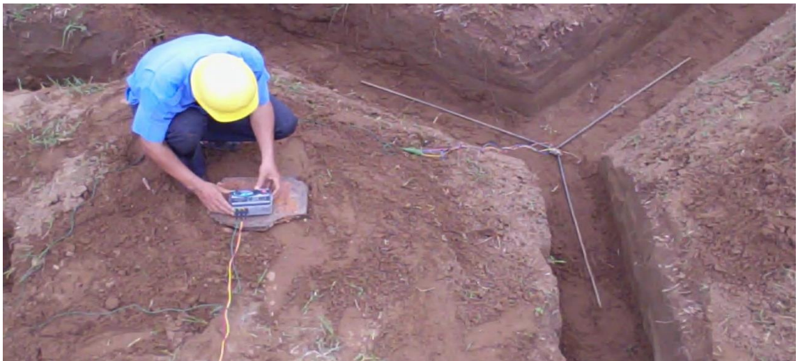
Hình 2.11: Hệ thống nối đất hình tia n = 3 , L_T = 1\text{m} , d = 0,01\text{m}
