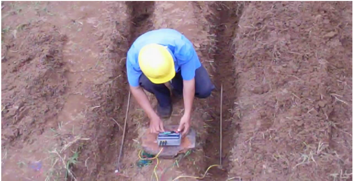
Hình 2.6: Hai thanh, a = 0,5\text{m} , L_T = 1\text{m} , d = 0.01\text{m}
