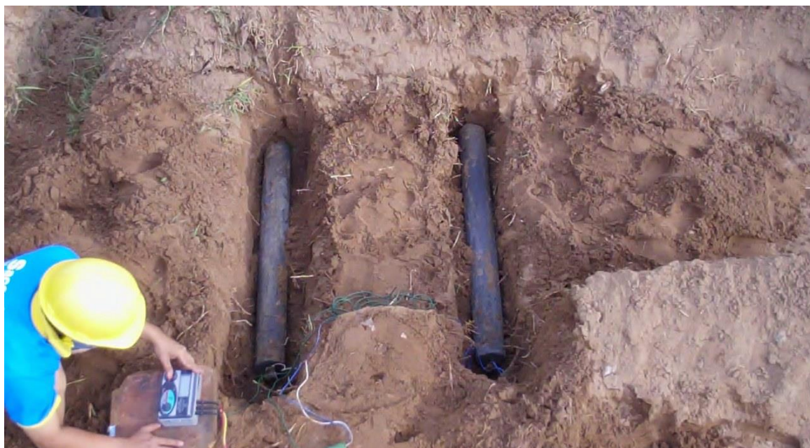
Hình 2.8: Hai thanh, a = 0,5m , L_T=1m , C= 0,05m
