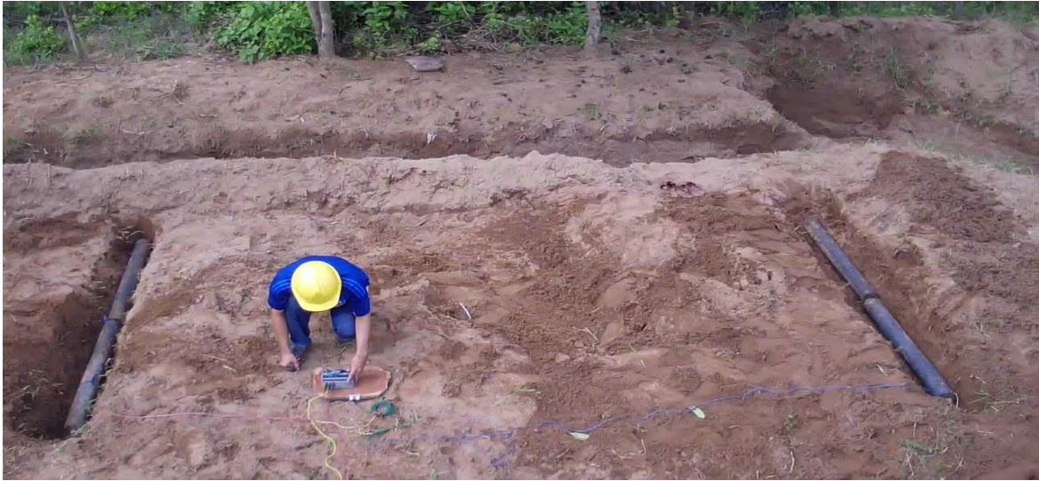
Hình 2.9: Hai thanh, a = 4\text{m} , L_T = 2\text{m} , C = 0,05\text{m}
